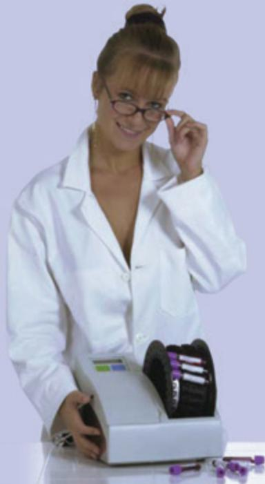
En option sur le MS9-5, son passeur automatique, le M-Sampler, permet le transfert direct des échantillons sans risque de contamination.
